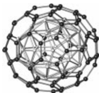
Abbildung 18. Der Fulleran-ähnliche \text{In}_{74} -Cluster und die endohedrale \text{Na}_{39} -Kugel (weiße Kugeln) in \text{Na}_{96}\text{In}_{97}\text{Ni}_2 . Der \text{In}_{10}\text{Ni} -Kern ist nicht dargestellt.
