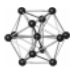
Abbildung 6. \text{Tl}_{13}^{10-} -Cluster in \text{Na}_4\text{K}_6\text{Tl}_{13} .
