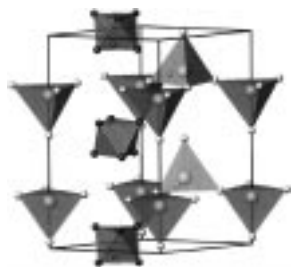
Abbildung 2. Struktur von \text{Ba}_5\text{Ga}_6\text{H}_2 mit trigonal-antiprismatischem \text{Ga}_6^{8-} und Hydrid-Ionen in Bariumtetraedern.
